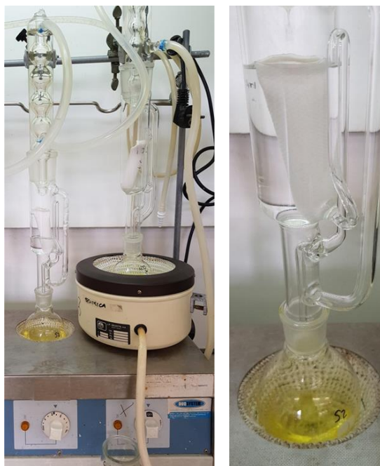
Figura 8. Montagem laboratorial do método de extração de Soxhlet.
