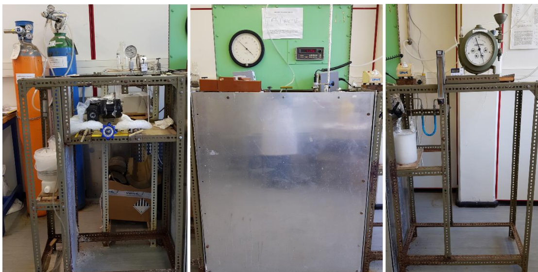
Figura 10. Montagem laboratorial do aparelho de extração supercrítica presente no Departamento de Bioenergia e Biorrefinarias do Laboratório Nacional de Energia e Geologia.
